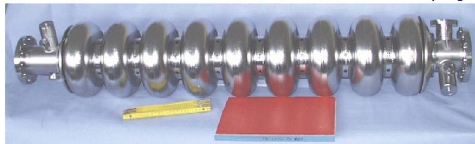
Die **Standard TESLA Beschleunigungsstruktur** wird als Stehwellenstruktur im  $\pi$ -Mode betrieben. Ein Hochfrequenz-Einkoppler speist bis zu 230 kW Leistung ein, über eine kleine Antenne wird das erzeugte Beschleunigungsfeld gemessen. Weitere Antennen bedämpfen möglicherweise angeregte Felder bei hohen Frequenzen.
