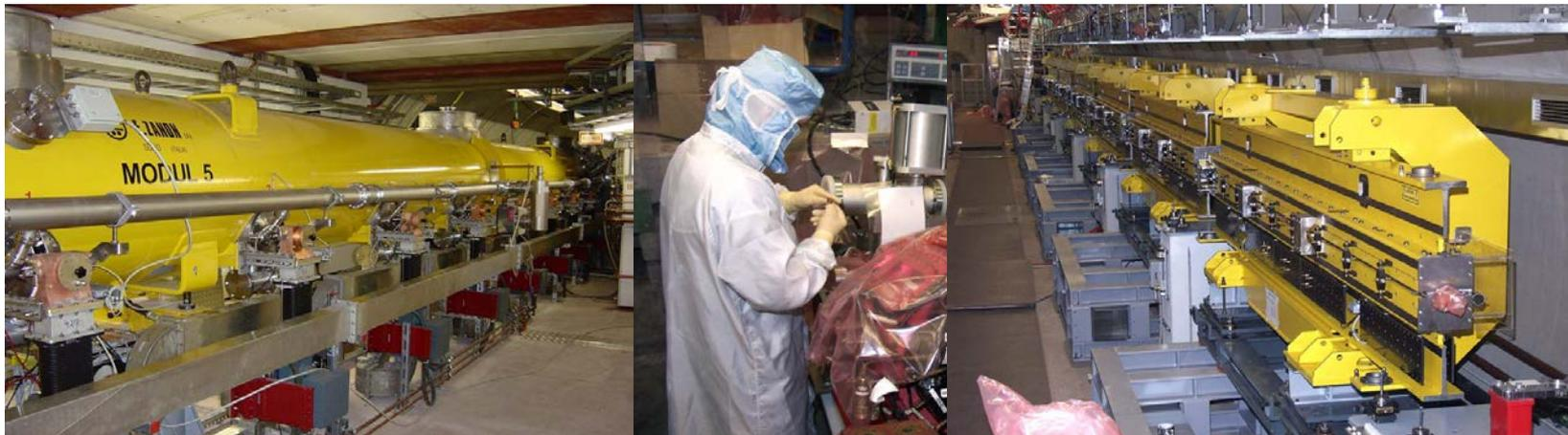
Insgesamt 7 Beschleunigermodule mit 56 einzelnen Strukturen wurden zusammengefügt. Es entstand der Freie-Elektronen Laser FLASH, eine weltweit sehr angesehene Anlage.
